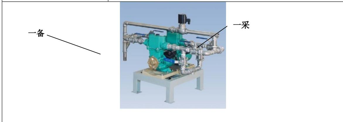
②根据现场条件选用潜水泵或自吸泵，采用双泵双管路设计，一用一备，控制系统中设置自动诊断泵故障及自动切换泵工作功能。当原水管压力不足时，系统将自动控制取水泵开启，以满足系统对进水的压力及水量的要求。两个水泵采用定时交替工作方式。
